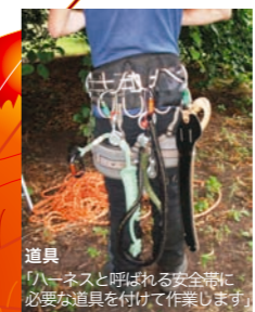
道具「ハーネスと呼ばれる安全帯」に必要な道具を付けて作業します
